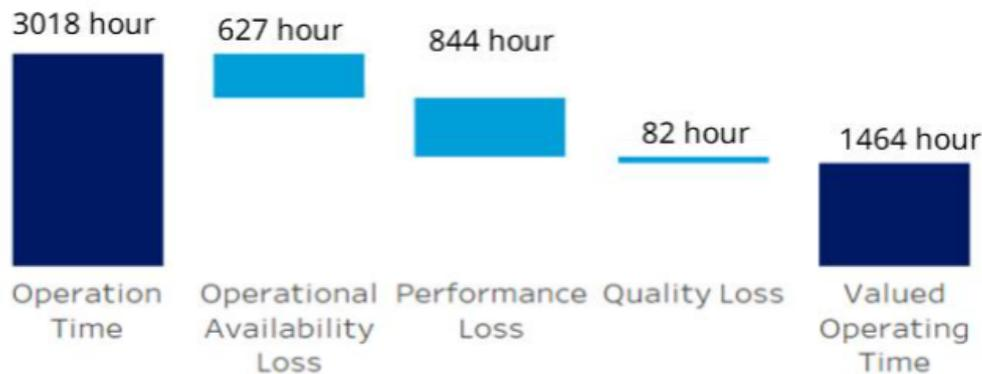
FIGURE 1.32 – Pertes de performance : ligne d'assemblage
