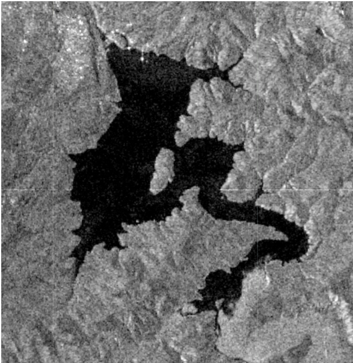
FIGURE 2.5 – Image SAR Sentinel-1 du barrage de Ghrib – polarisation (VV), mode IW.
