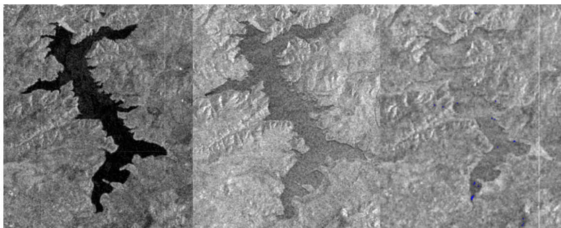
FIGURE 4.1 – Variabilité de la signature radar du barrage d'Aïn Zada - Images SAR Sentinel-1 (polarisation VV, mode IW) acquises à quelques jours d'intervalle .
