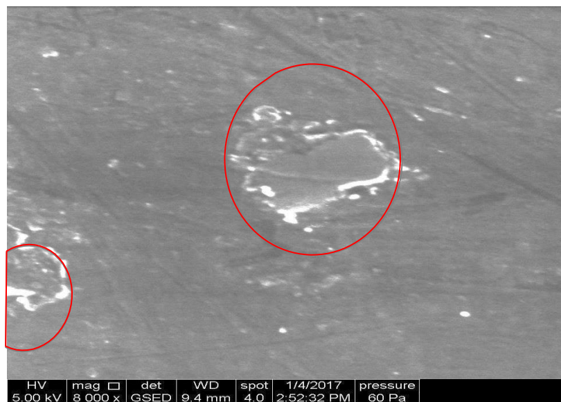
Figure III. 10 : Morphologie PET après vieillissement (x8000).
