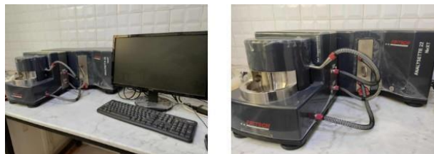
FIGURE 5.8 – Appareil de granulométrie laser FRITSCH – ANALYSETTE 22 NeXT utilisé pour l'analyse de la distribution granulométrique du carbonate de calcium.
