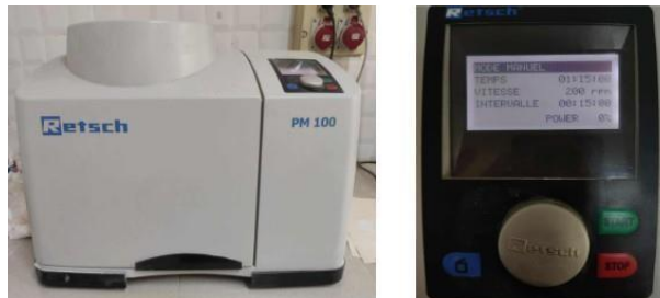
FIGURE 5.6 – Broyeur planétaire à billes RETSCH PM 100 utilisé pour la micronisation du carbonate de calcium.
