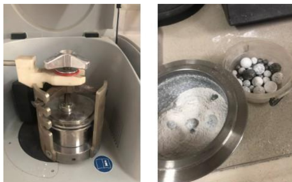
FIGURE 5.7 – Vue du bol de broyage et des billes en acier de tailles différentes utilisés dans le broyeur planétaire RETSCH PM 100.
