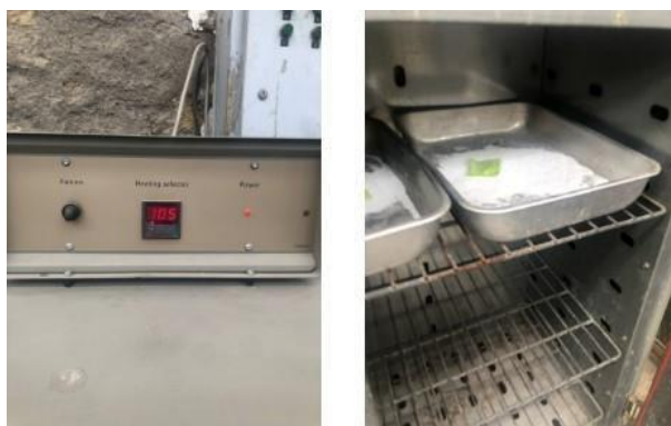
FIGURE 5.5 – Étape de séchage du carbonate de calcium dans une étuve
