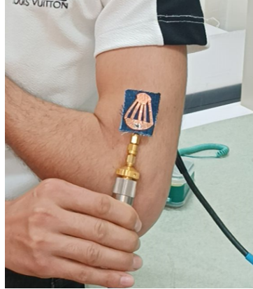
FIGURE 6.8 – Placement de l'antenne fabriquée sur le bras humain..
