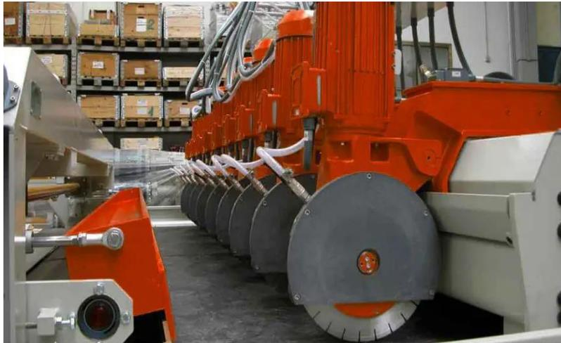
Figure 25 Ligne de dimensionnement à disques diamantés
