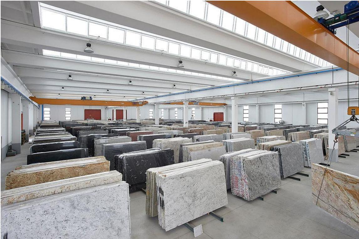
*Figure 30 Stockage et manutention des dalles finies sur des chevalets à l'aide du pont roulant*
