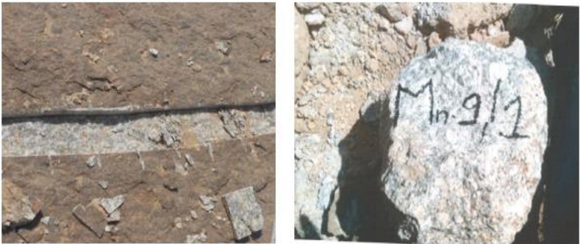
*Figure 8 échantillons des saignées de surface et des monolithes*
