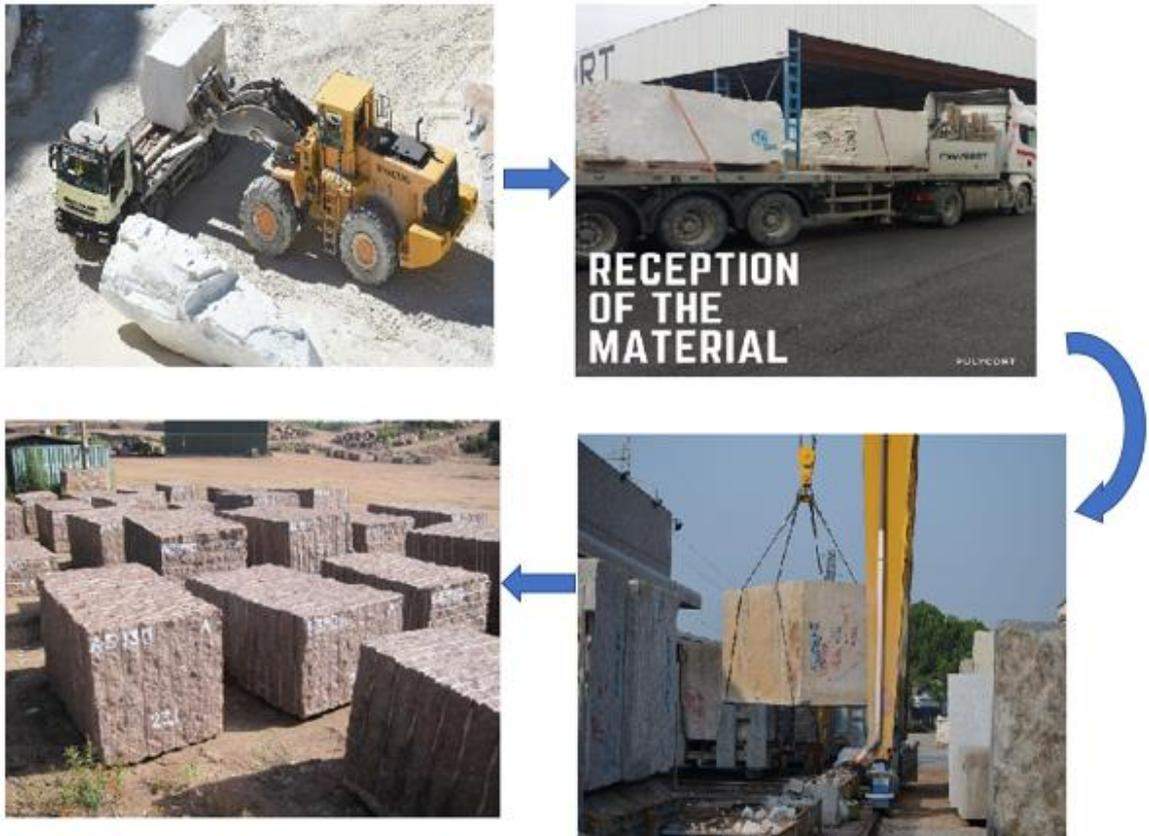
Figure 19 étapes de manutention et transport des blocs
