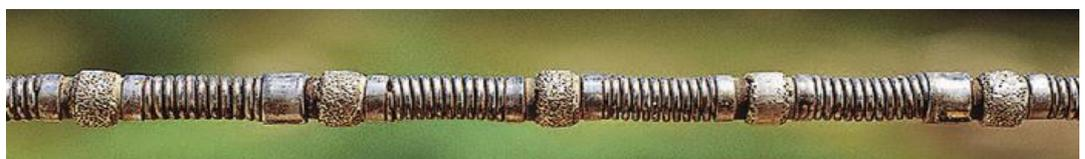
Figure 14 Câble diamanté
