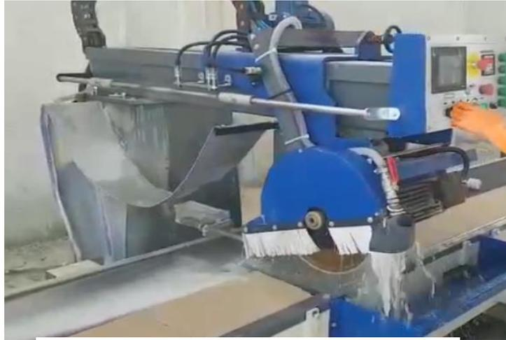
Figure 22 : machine de découpage de têtes irrégulières.
