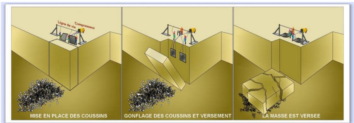
Figure 17 Les étapes de versement des blocs avec les coussins.
