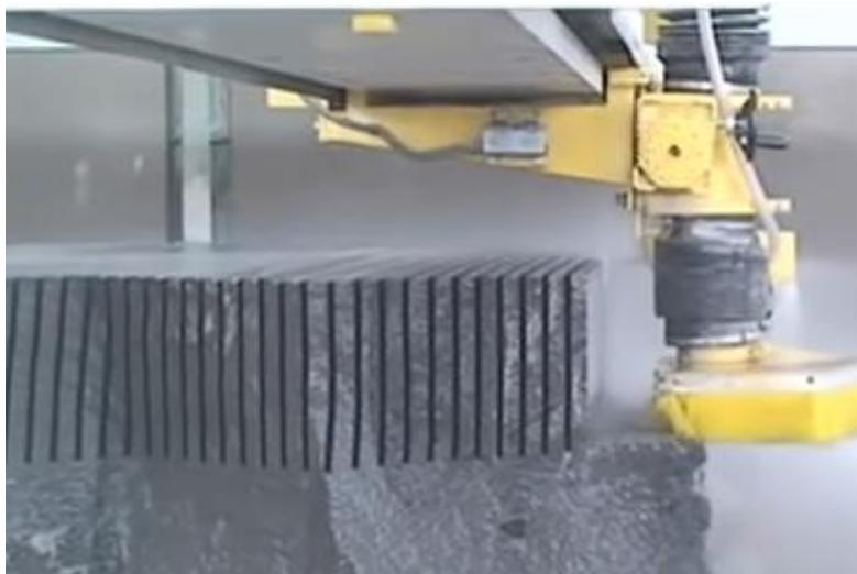
*Figure 21 : machine de découpage horizontal mono-disque*
