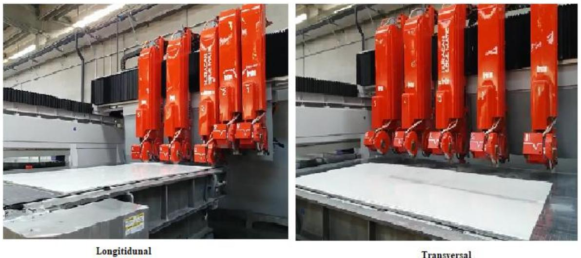
Figure 27 Ligne de dimensionnement à deux machines (deux sens)
