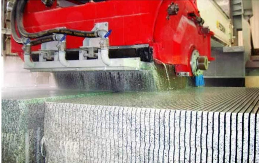
*Figure 20 unité de découpage à multi-disques diamantés [10]*
