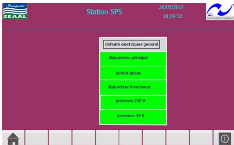
Figure V-7 Vue défauts électriques générales.
