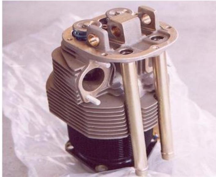
Figure 1-1 Cylindre de bloc moteur avec ailette de refroidissement
