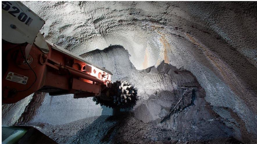
Figure 3 : Machine à attaque ponctuelle. [30]
