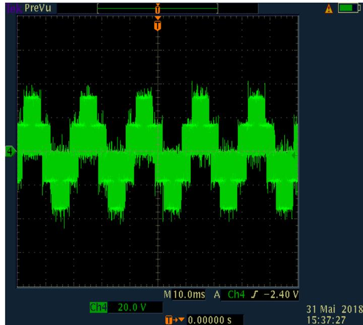
Figure 4.32 : La tension simple  $V_{1n}$ .
