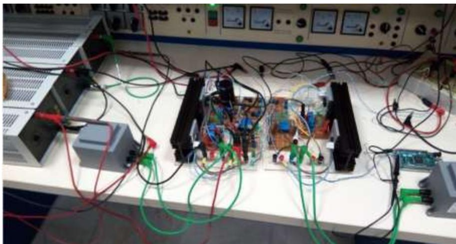
Où on a utilisé la carte Arduino Due pour générer le signal de commande, la paillasse pour alimenter les HCPLs, l'alimentation stabiliser pour alimenter les capteurs et on a utilisé les trois charge 100Ω/6A.
