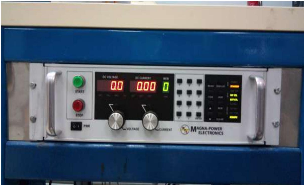
Figure 4.2 : L'émulateur PV (Magna Power Electronics 600V / 24A).
