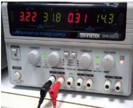
Figure 4.11 : Alimentation stabilisée
