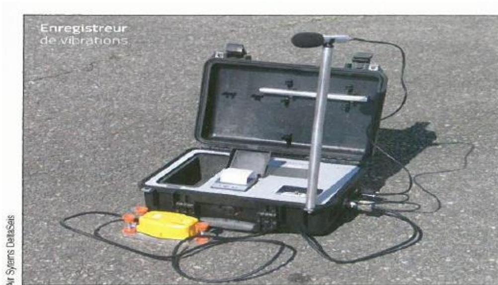
**Figure III.6** Enregistreur de vibrations (sismographe).
