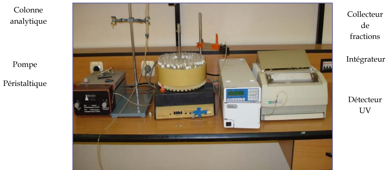
Figure 14 : Dispositif de la chromatographie d'exclusion moléculaire sur Séphadex G-75 utilisé pour la détermination du poids moléculaire.
