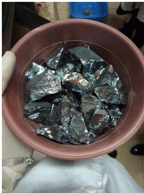
Figure IV-2. Le concassage primaire du morceau de silicium.
