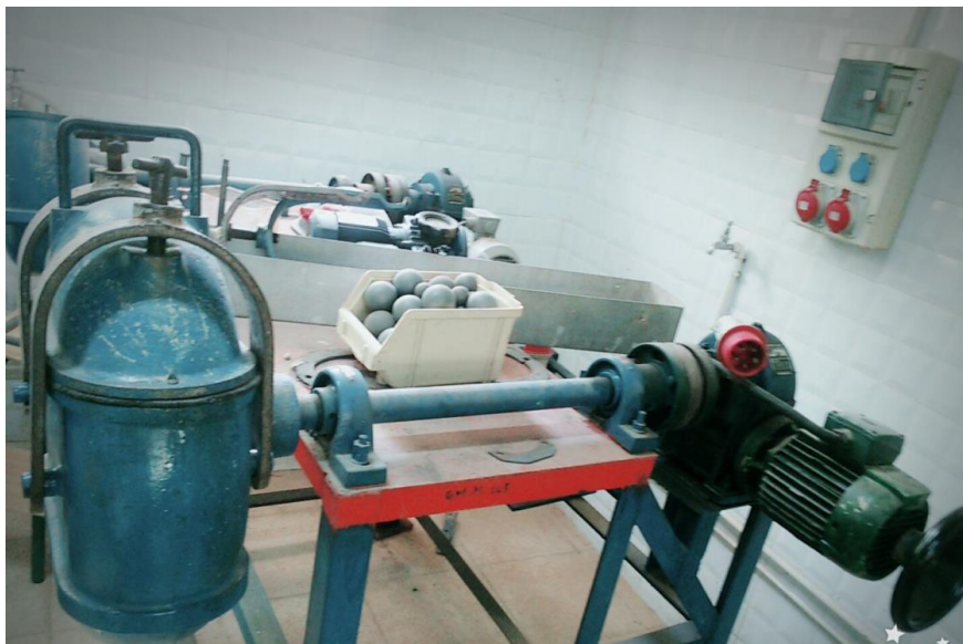
Figure II-4. Broyeur à boulets [27].
