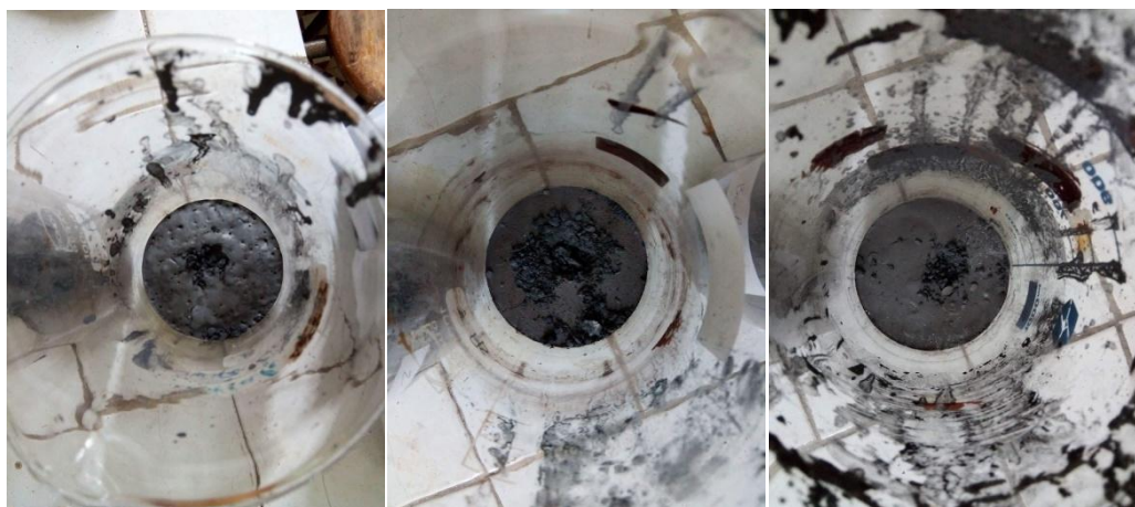
Figure IV-10. Allure de la phase solide récupérée du slurry dissout dans l'acétone agitée pendant 1/2h, 1h et 1h ½ min, respectivement.
