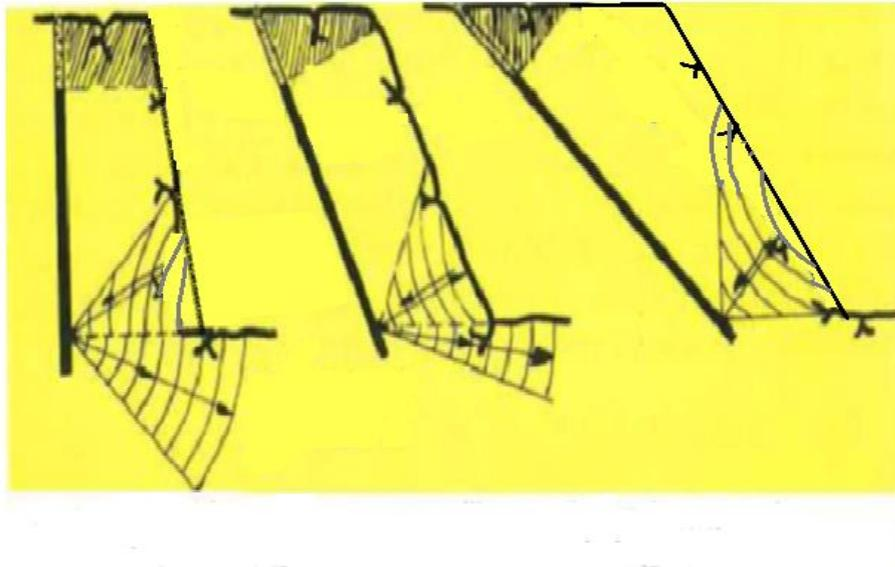
Figure III.3: L'effet de l'onde de choc au pied selon l'inclinaison du trou.
