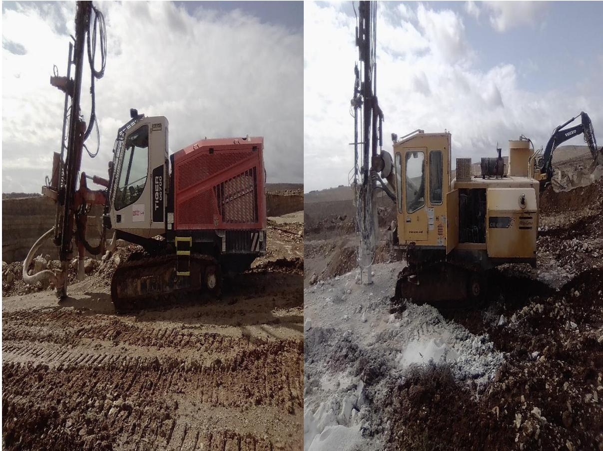
Figure III.12: Les deux chariots de forage présents dans la carrière
