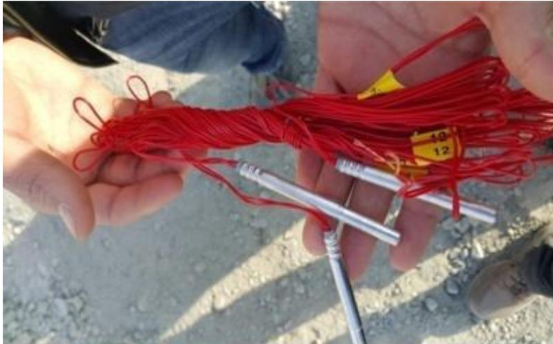
Figure.III.10 : Photo représente le détonateur micro retard (D.M.R)
