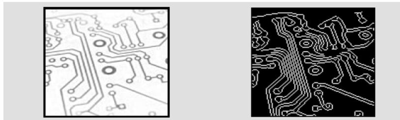
Figure IV.8 : Image originale (à gauche), Image des contours (à droite).
