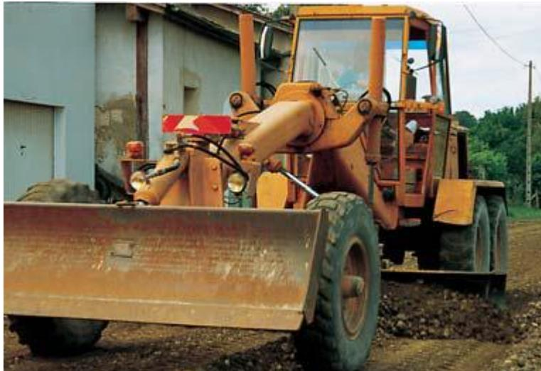
Figure 11 niveleuse de réglage
