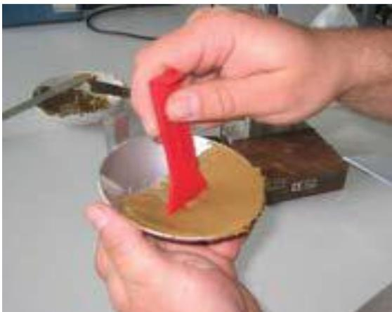
Figure 22 Réalisation de la rainure dans la pâte de sol
