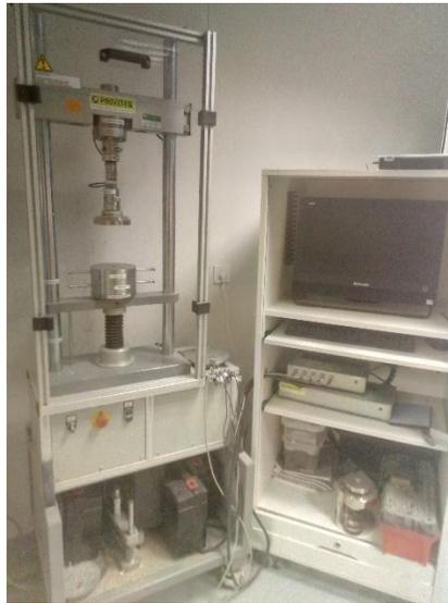
Figure 28 : presse de poinçonnement
