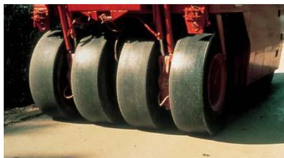
Figure 13 un rouleau a bandage caoutchouc
