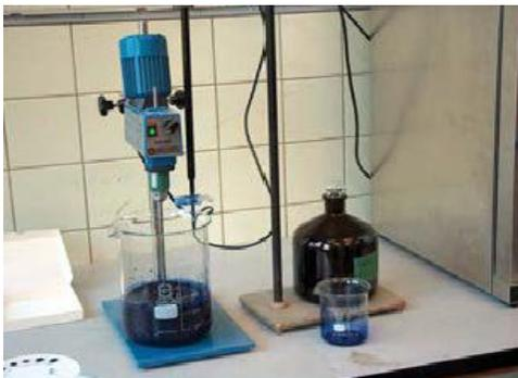
Figure 18 Appareillage pour essai au bleu de méthylène
