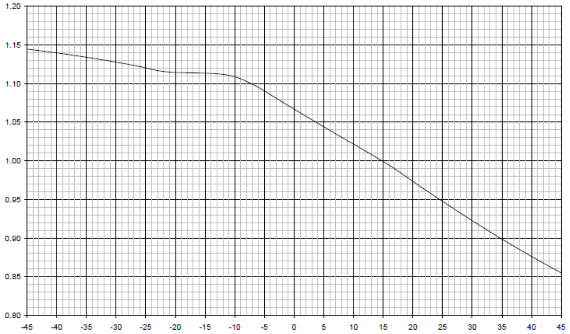
Fig. A.4: Evolution du pourcentage de la consommation de chaleur en fonction de la température ambiante
