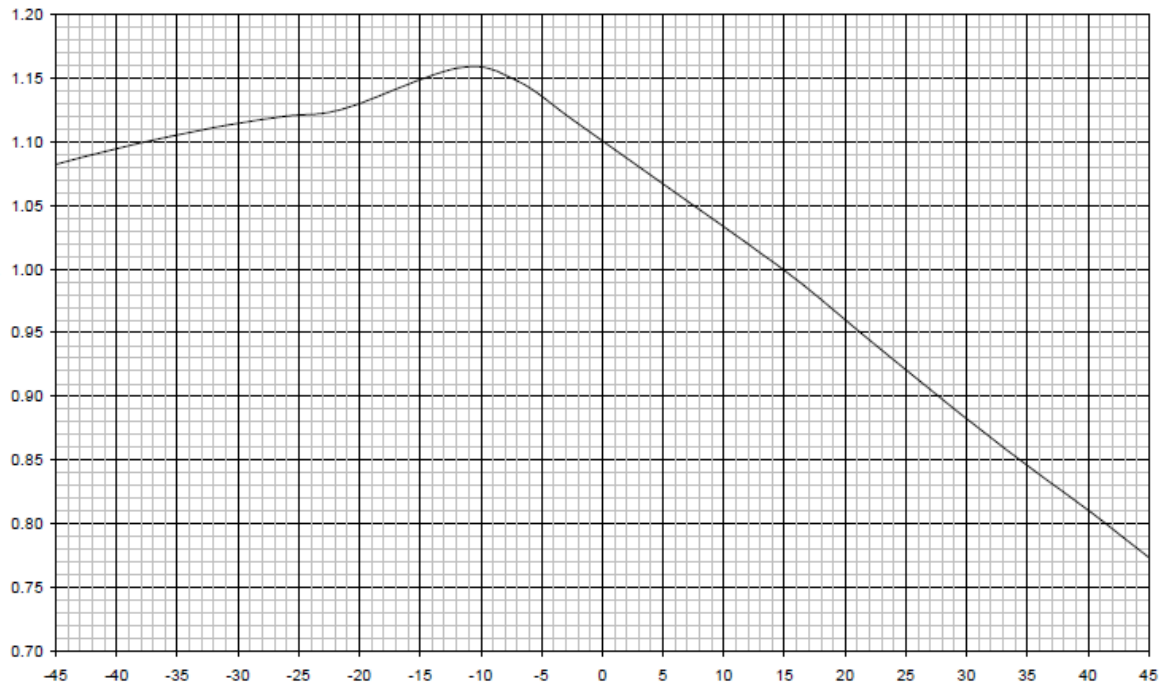
Fig. A.2 : Evolution de la puissance générée en fonction de la température ambiante
