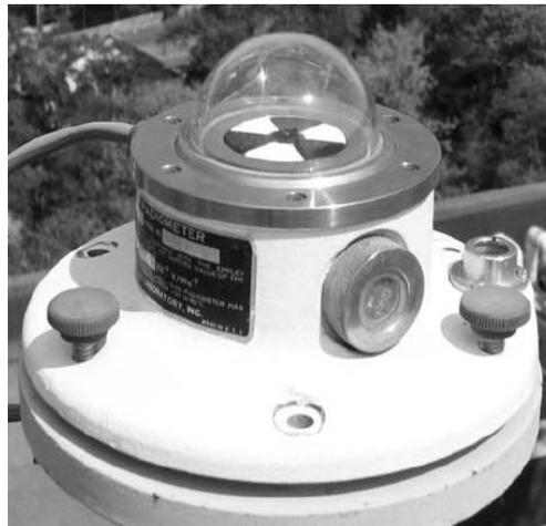
Figure I-2 Photo d'un Pyranomètre Eppley modèle PSP [1].
