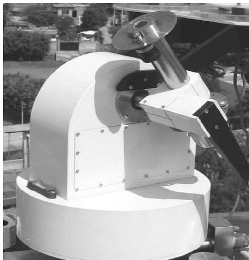
Figure I-3 Photo d'une pyréliomètre [1].
