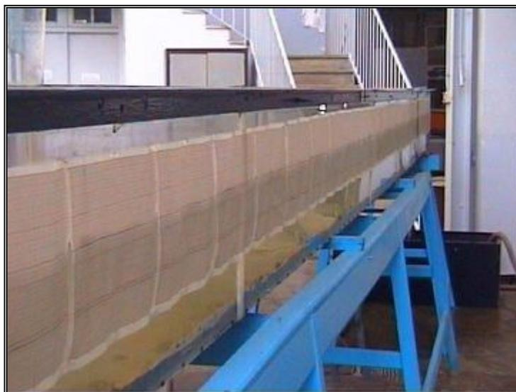
**Photographie IV.2** : Dispositif de mesure de la hauteur d'eau (Papier millimétré).
