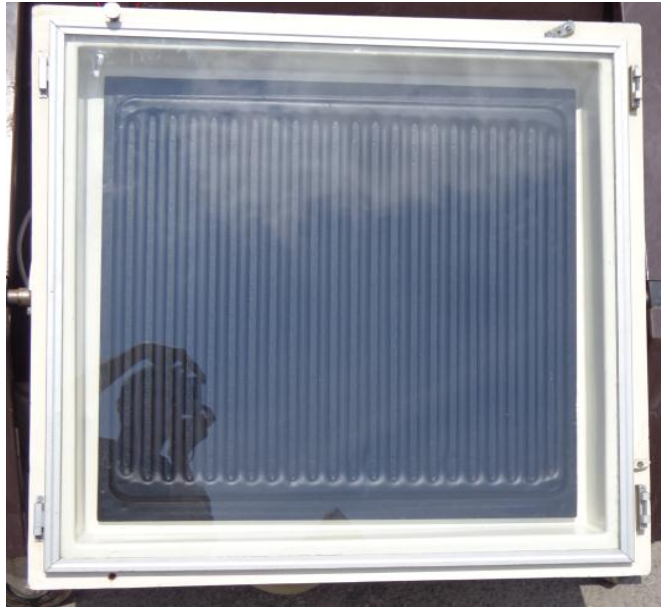
Figure 4- 3 : Représentation du capteur solaire plan
