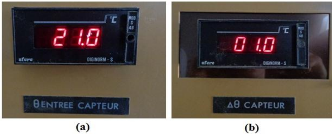
Figure 4- 13 : Afficheurs des températures : (a)- à l'entrée (b)-différence de température
