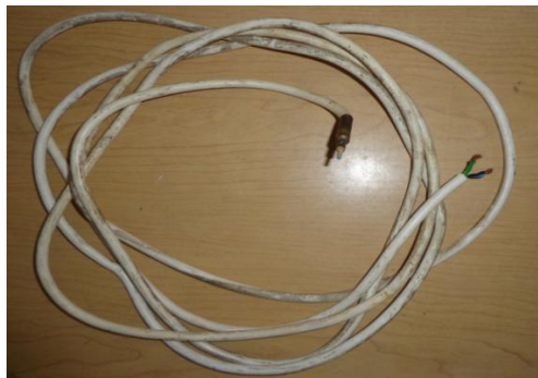
Figure 4- 11 : Le thermocouple défectueux
