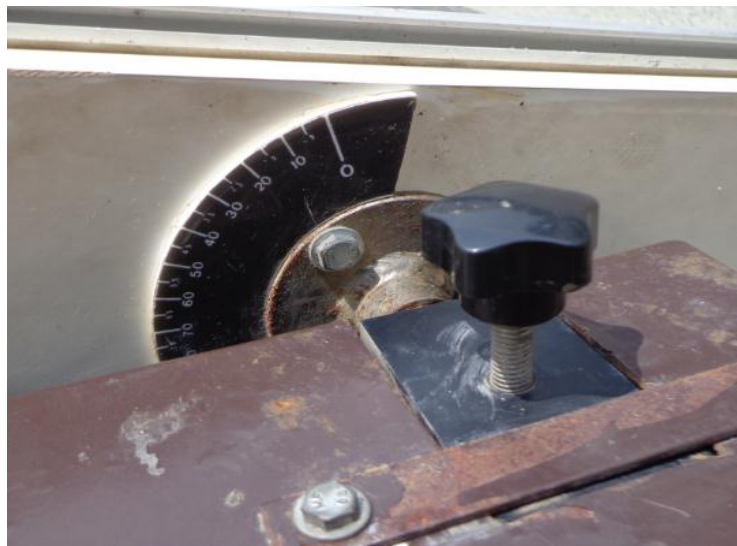
Figure 4- 2 : Système permettant de changer l'angle d'inclinaison \beta
