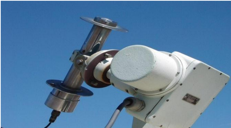
Figure 1-12 : Pyréliomètre mesurant le rayonnement direct
