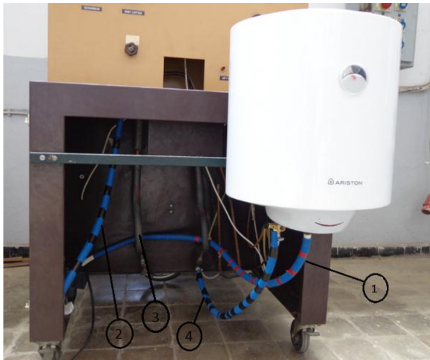
Figure V- 4 : Circuit du fluide caloporteur du banc d'essais
