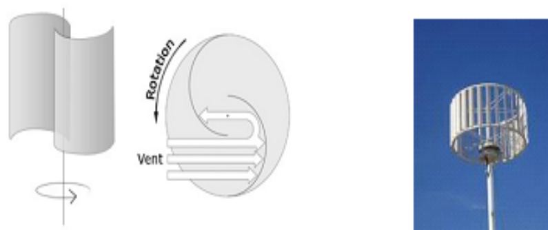
FIGURE 1.12 – Une éolienne de type Savonius (droite) et son schéma de fonctionnement (gauche) [7]
