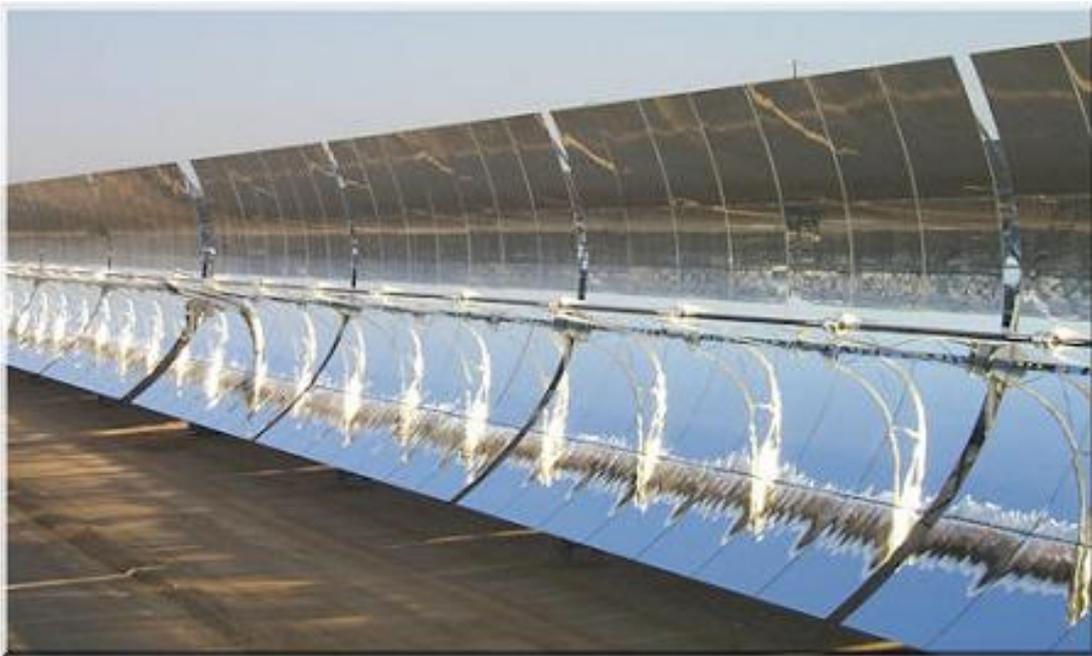
**Figure II.7. Concentrateurs cylindro-paraboliques.**
