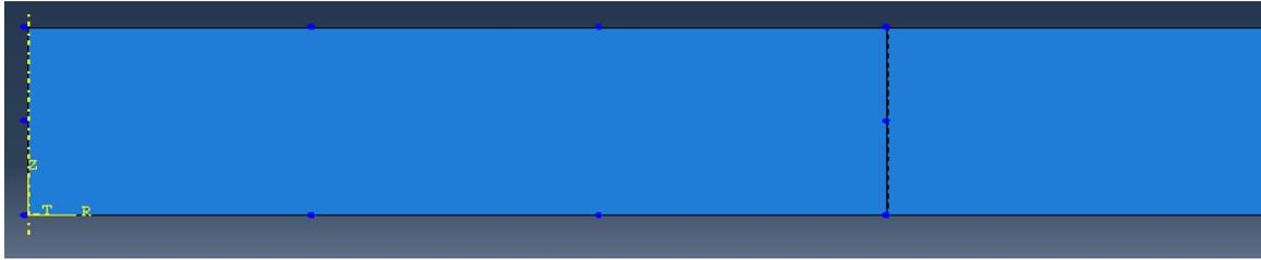
Figure.IV.10 : Conditions aux limites du frettage avec axisymétrie prenant en compte la torsion
