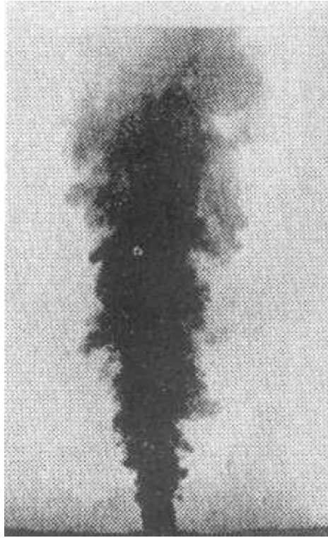
Figure 5: Photographie d'un panache (injection d'eau chaude colorée dans de l'eau froide) [Turner 1973]
