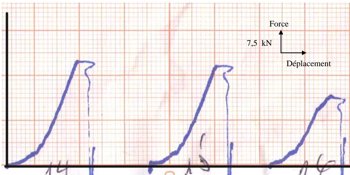
Figure III-6 : Courbes de traction d'une éprouvette de référence (n14) et celles endommagées (n15 et 16) pour une distance entre entailles X=7.5\text{mm} .
