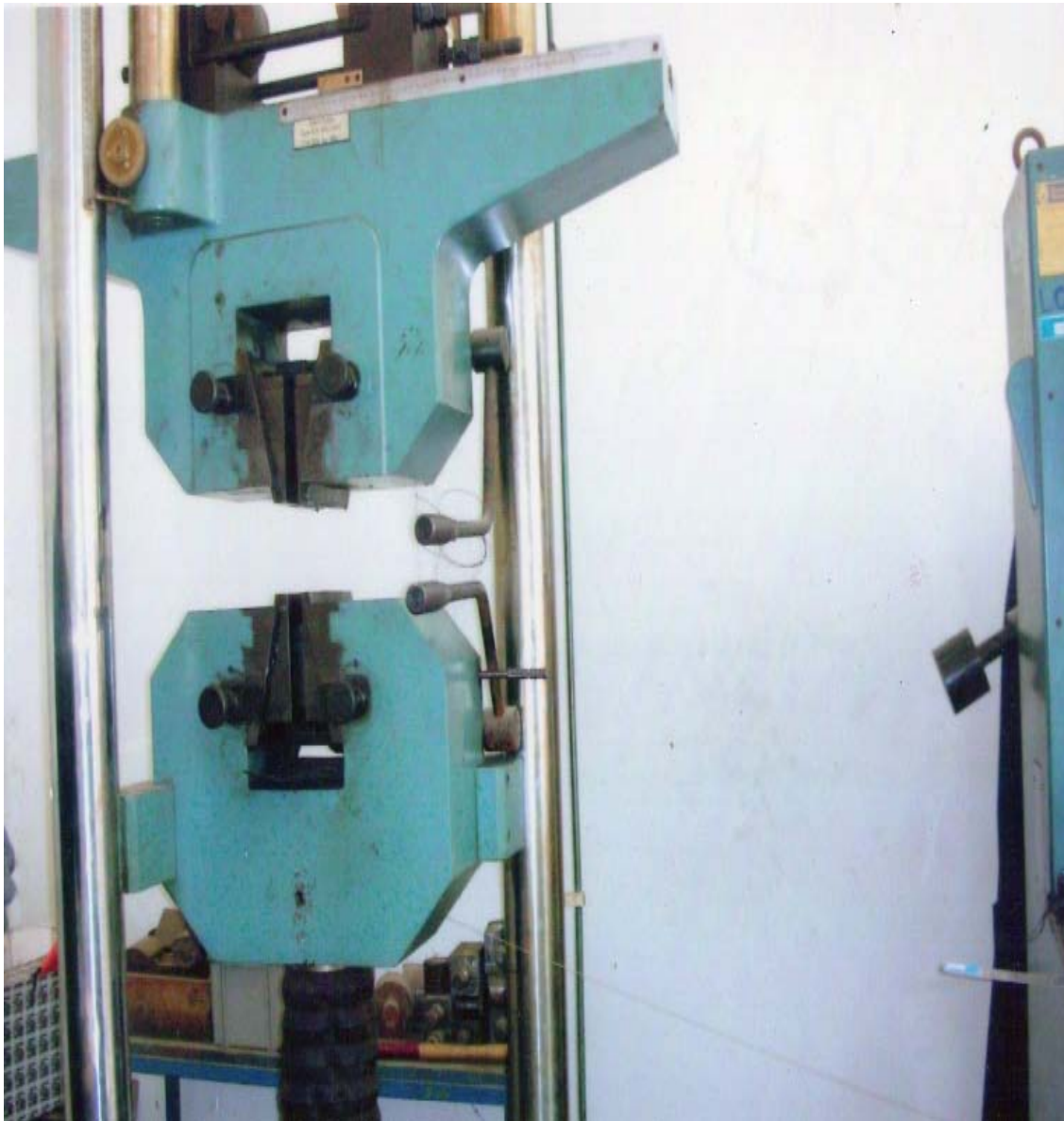
Photo III-3 : Machine de traction monotone utilisée.
