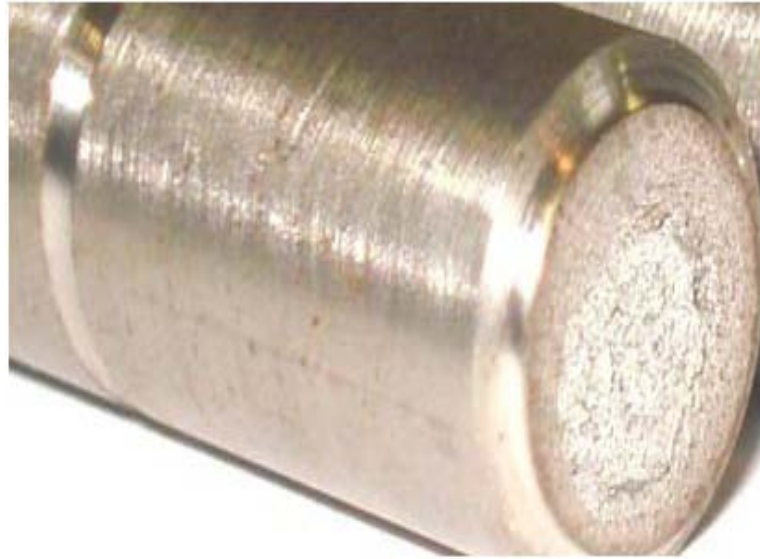
Photo III-7 : Faciès de rupture d'éprouvette endommagée de X=17.5\text{mm} .
