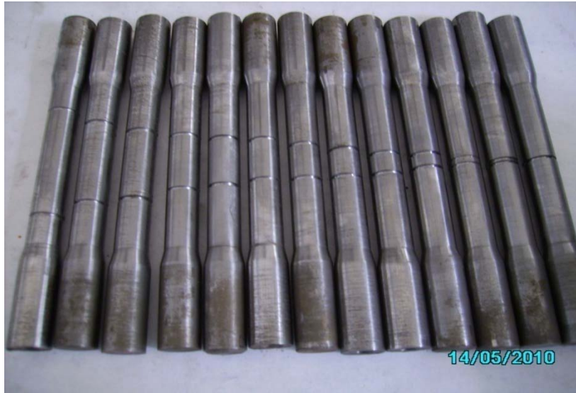
Photo III-1 : Variation de la distance X entre entailles.
