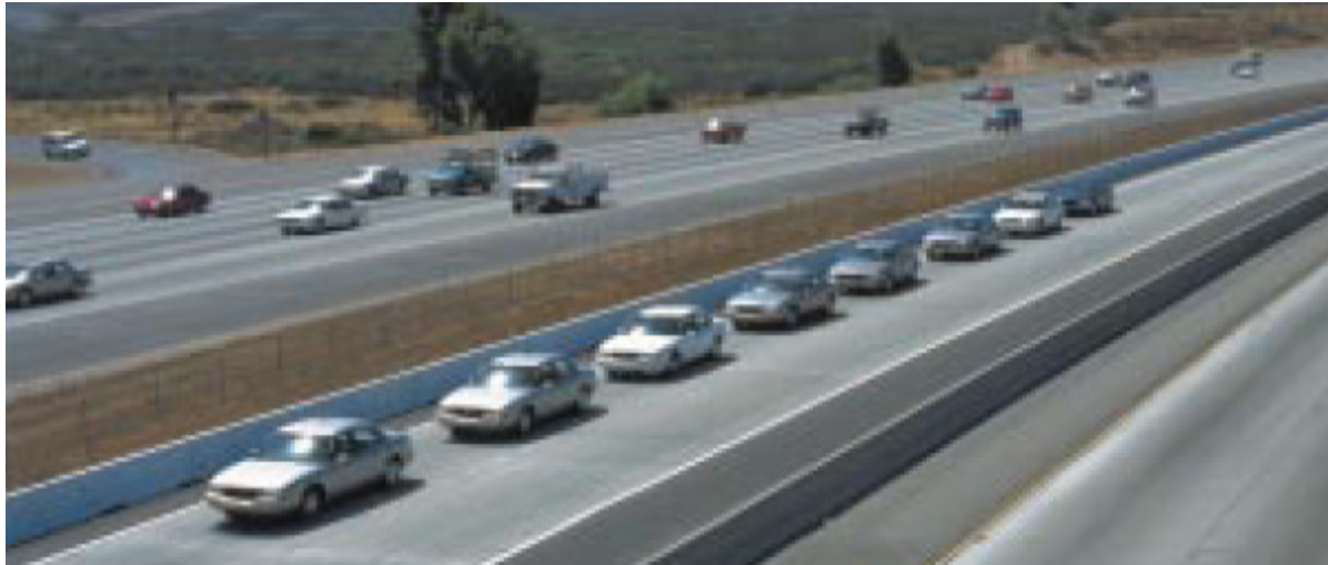
Figure-3.14 : peloton de voiture sur une autoroute dans le cadre d'un AHS
