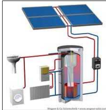
Figure I.3 Exemple de production de l'eau chaude sanitaire à l'aide d'un capteur solaire thermique
