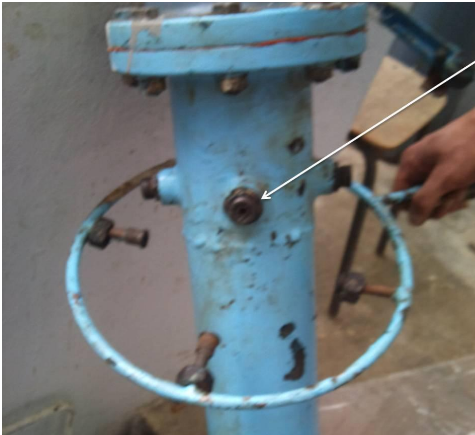
Figure III.10 : Système de prise de pression démonté.
