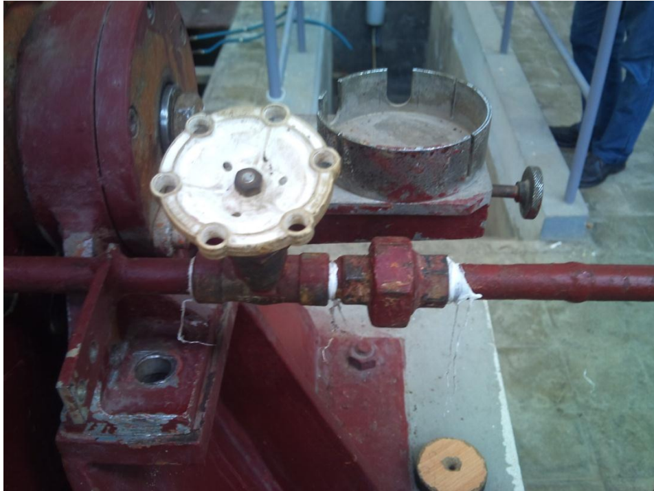
Figure III.11_1 : Démontez la vanne du circuit de refroidissement.
