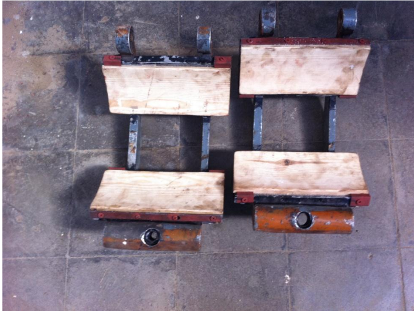
Figure III.13 : Fixation des patins en bois sur les sabots du frein.
