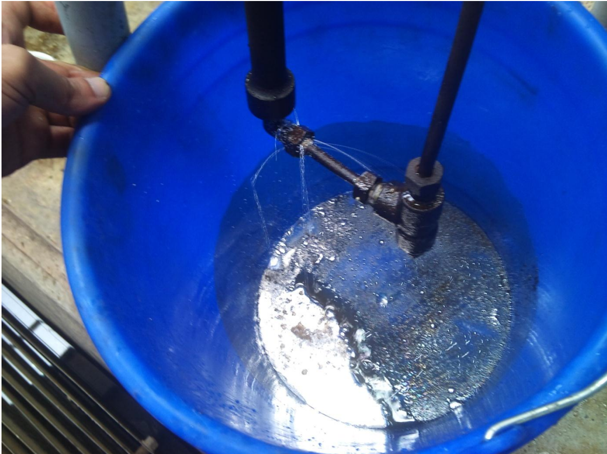
Figure III.4 : Extraction du mercure du dispositif de mesure du débit.
