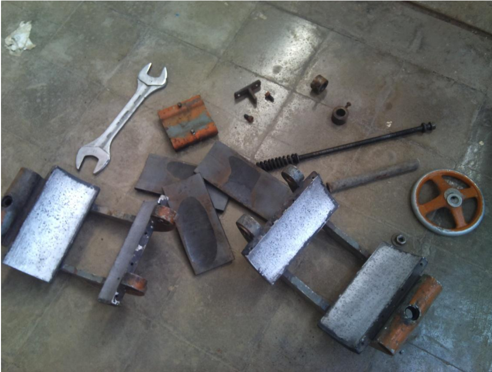
Figure III.11_5 : Retirer enfin les sabots.
