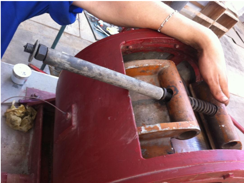
Figure III.11_2 : Dévisser le volant du frein.
