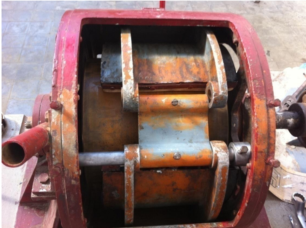
Figure III.11_4 : Dévisser les vis qui retiennent les axes et les anneaux, puis retirer les axes.
