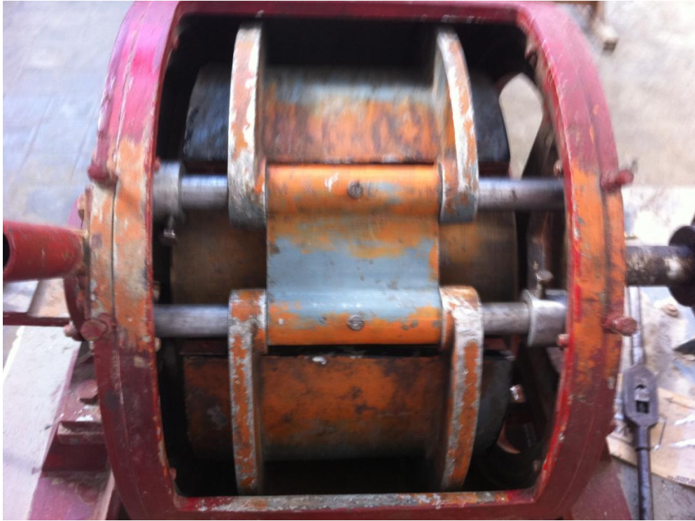
Figure III.11_3 : Retirer les vis et la butée du frein qui se trouve à sa partie inférieure puis retourner le frein complètement.
