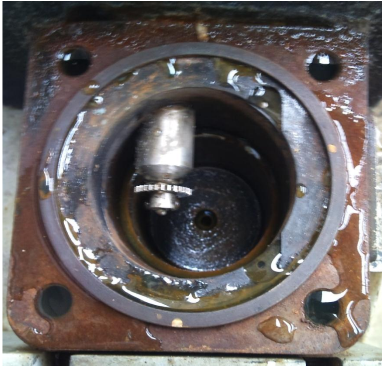
Figure III.3 : Etat du cylindre où loge le mécanisme de commande de l'aiguille du débitmètre avant nettoyage et graissage.
