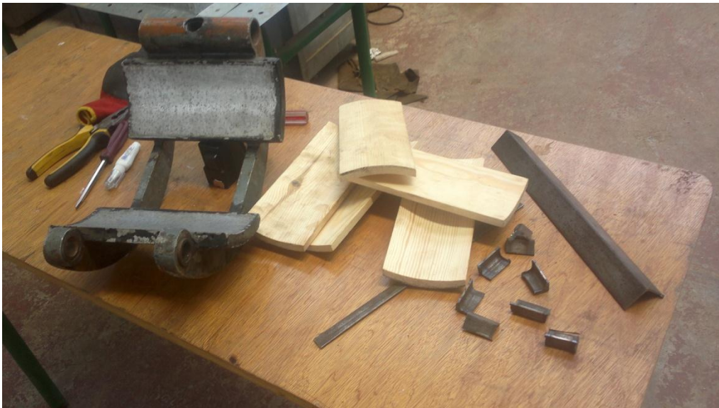
Figure III.12 : Réalisation des patins par usinage du bois pour leur faire épouser la forme des sabots.
