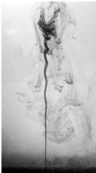
Figure 1.7 : Visualisation de fontaine à \text{Fr} = 5515 et \text{Re} = 210 avec U=27.6\text{cm s}^{-1} , D=0.76\text{mm} , \Delta\rho/\rho=0.00186
