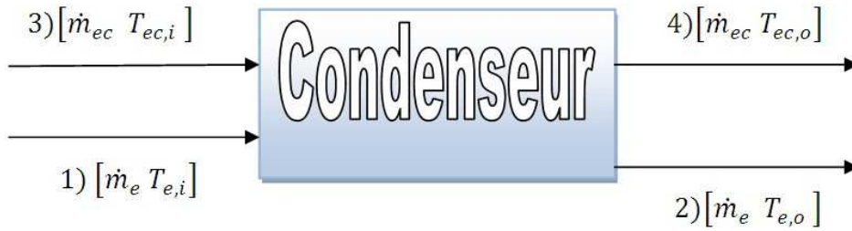
Fig. III.5 : Bilan énergétique du condenseur
