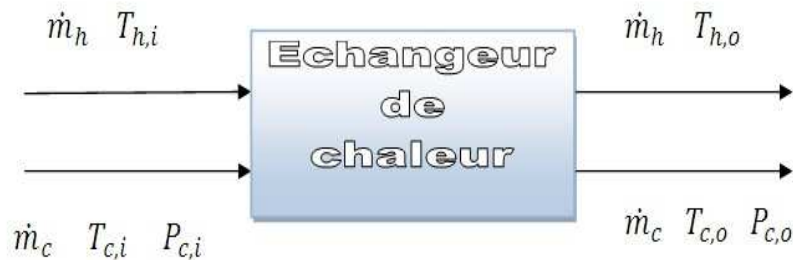
Fig. II.9 : Bilan énergétique d'un échangeur de chaleur
