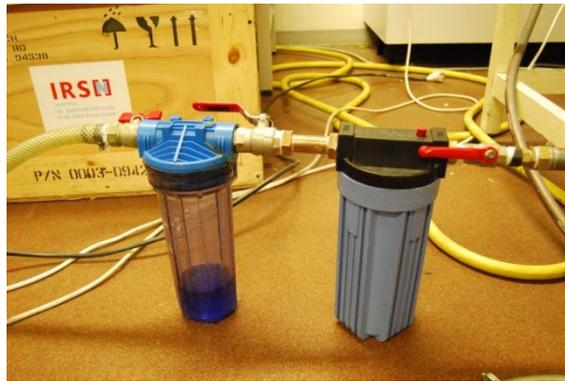
Figure 51 : dispositif d'ensemencement de l'hélium
