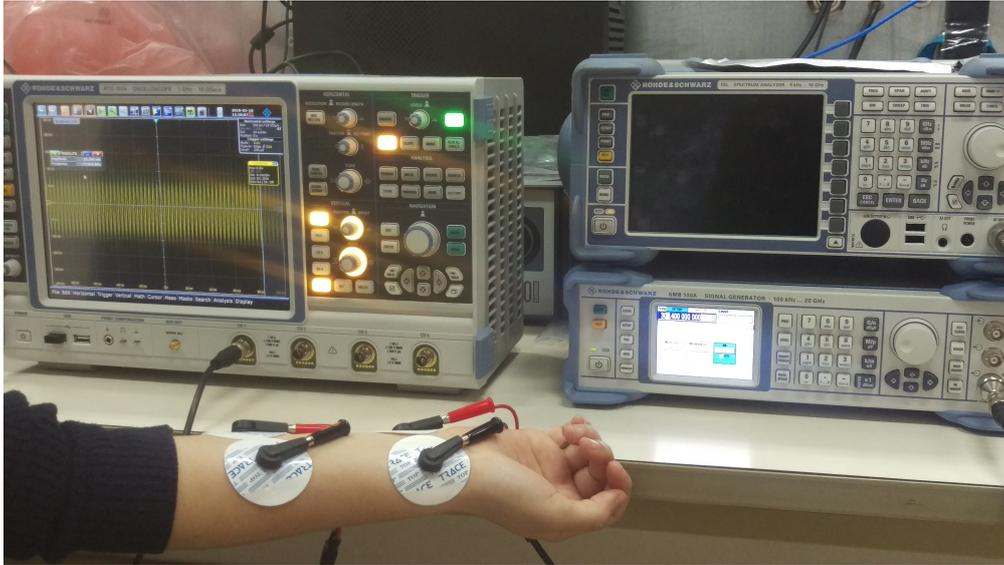
FIGURE 3.6 – Banc expérimental de mesure pour couplage galvanique HBC réalisé sous la première configuration (type d'électrode : ECG, longueur du canal :10cm et distance transversale : 5cm).
