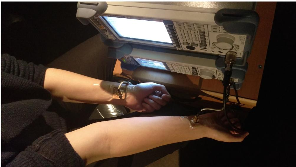
FIGURE 3.5 – Banc expérimental de mesure pour couplage capacitve HBC réalisé sous la deuxième configuration (type d'électrode : patch et longueur du canal :10cm,chambre anéchoïque).
