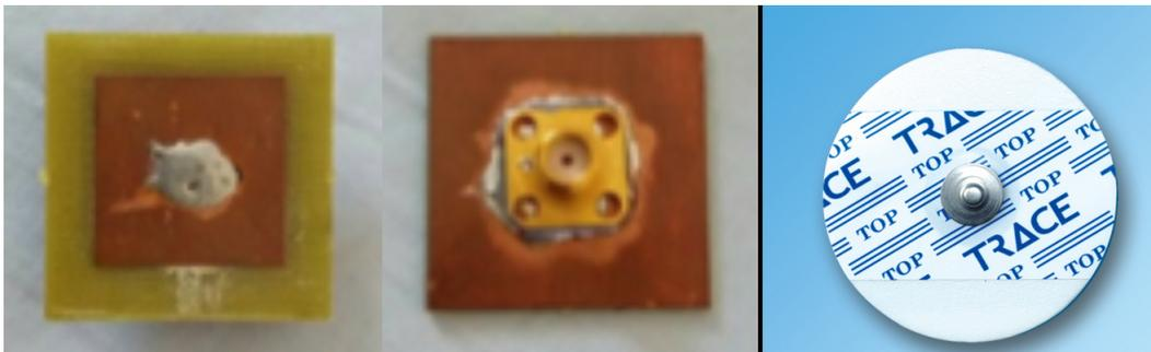
FIGURE 3.1 – antenne patch, Electrode ECG et Balun.
