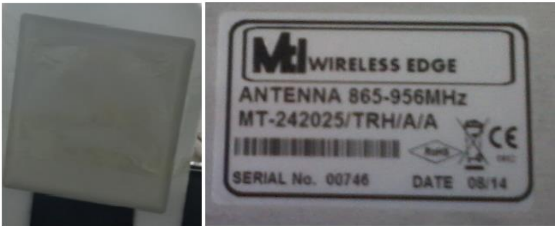
Figure 3. 6: Antenne adéquate au lecteur M6e
