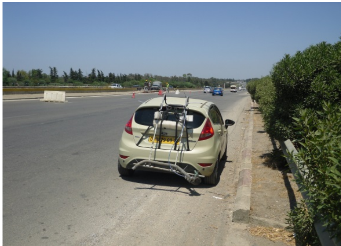
Figure III.13 : Photos de véhicules équipés et laboratoire d'analyse pour la campagne de mesure des émissions
