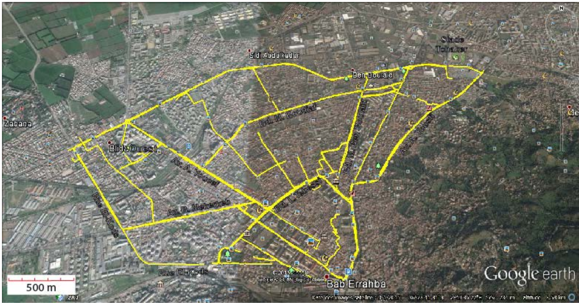
Figure III.6 : Ensemble des trajets de 75 véhicules suivis dans la commune de Blida
