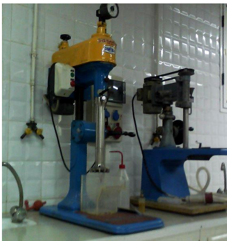
Fig IV.15 : Cellule de flottation (DENVER)
