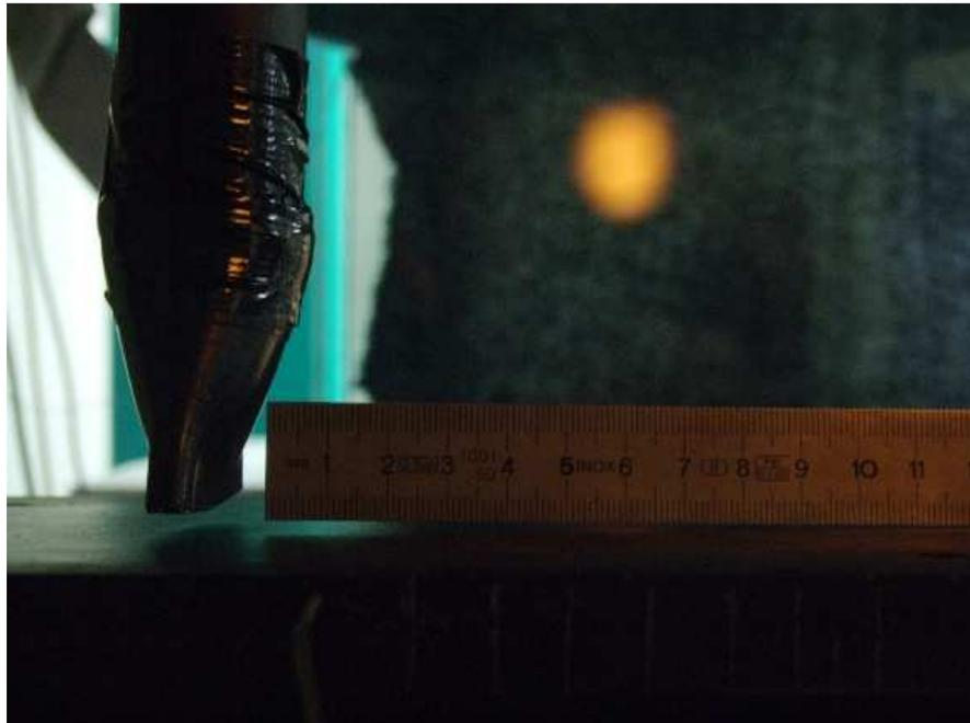
Fig. C.4. Calibrage pixel-mm à l'aide d'une règle pour  $H=e$
