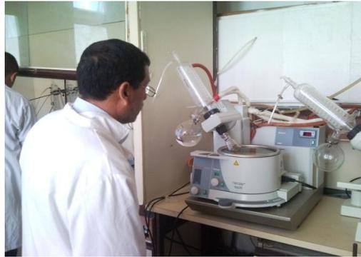
Figure III 12. Evaporateur rotatif ( LABORATA 4000-efficient Heidolph).
