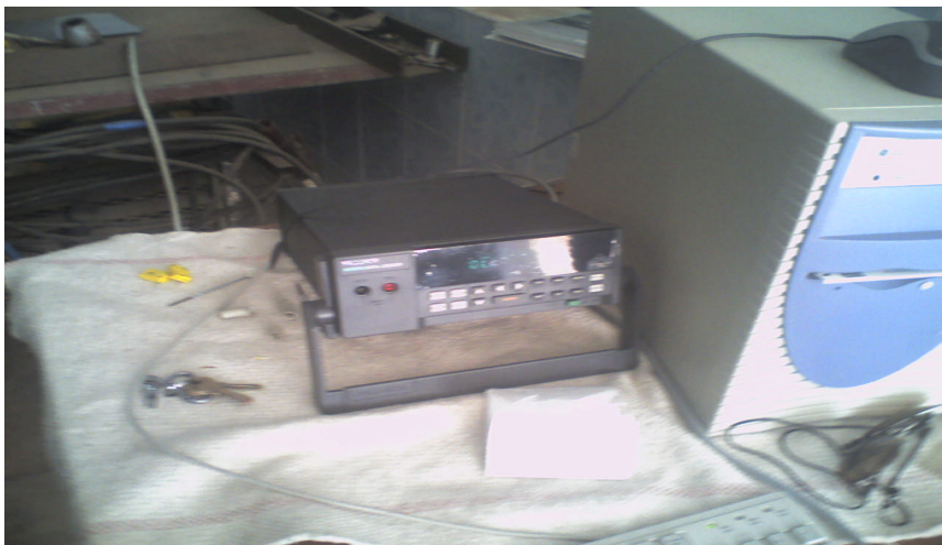
Figure VI.3 enregistreur des cycles thermiques
