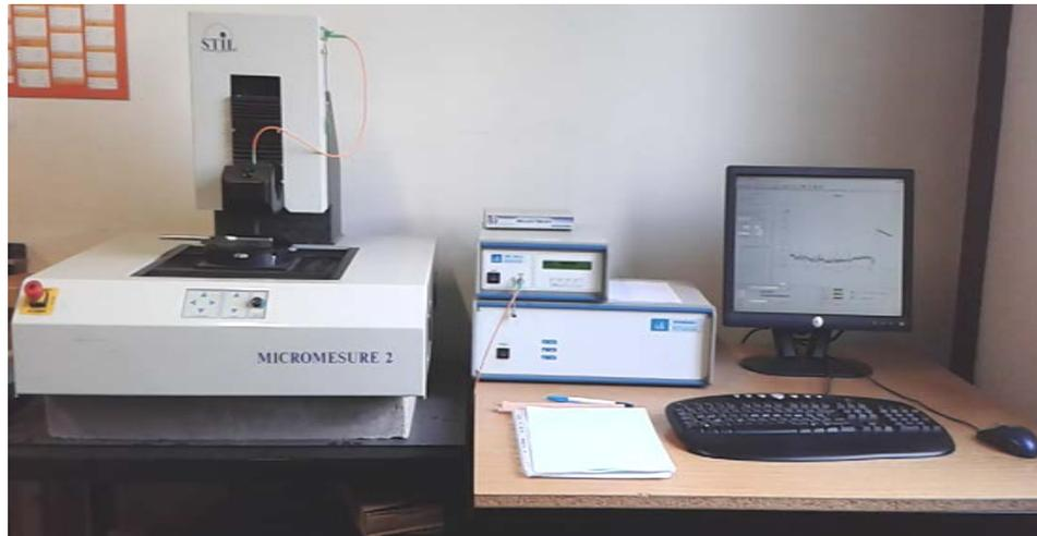
**Figure 5.4 :** Dispositif expérimental pour mesure de l'état de surface
