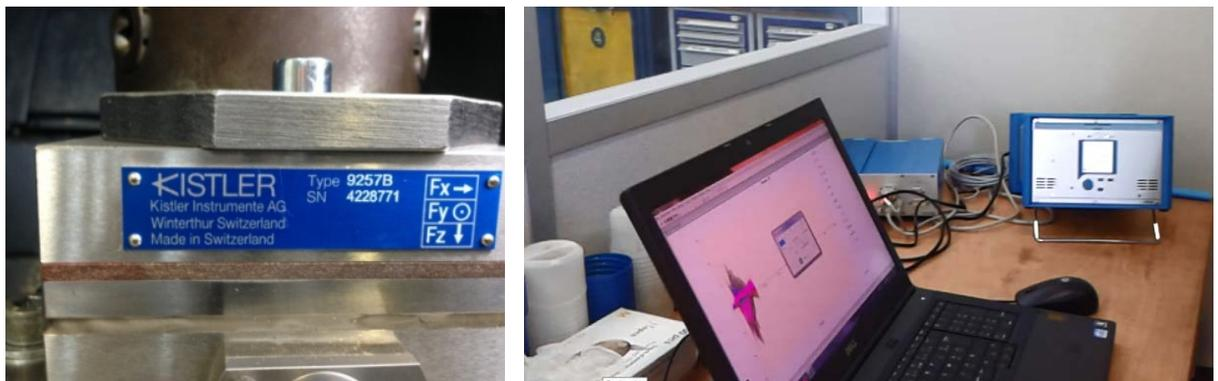
**Figure 5.3** : Dispositif expérimentale pour mesure des efforts
