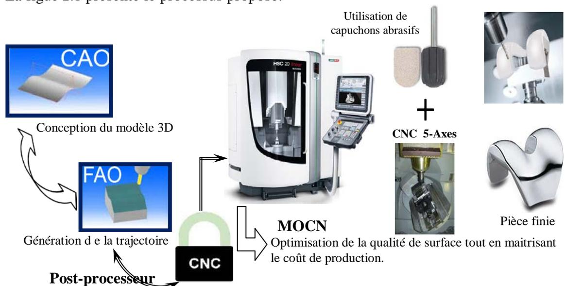
**Figure 2.1 :** Processus de pré-polissage effectué sur une machine CNC
