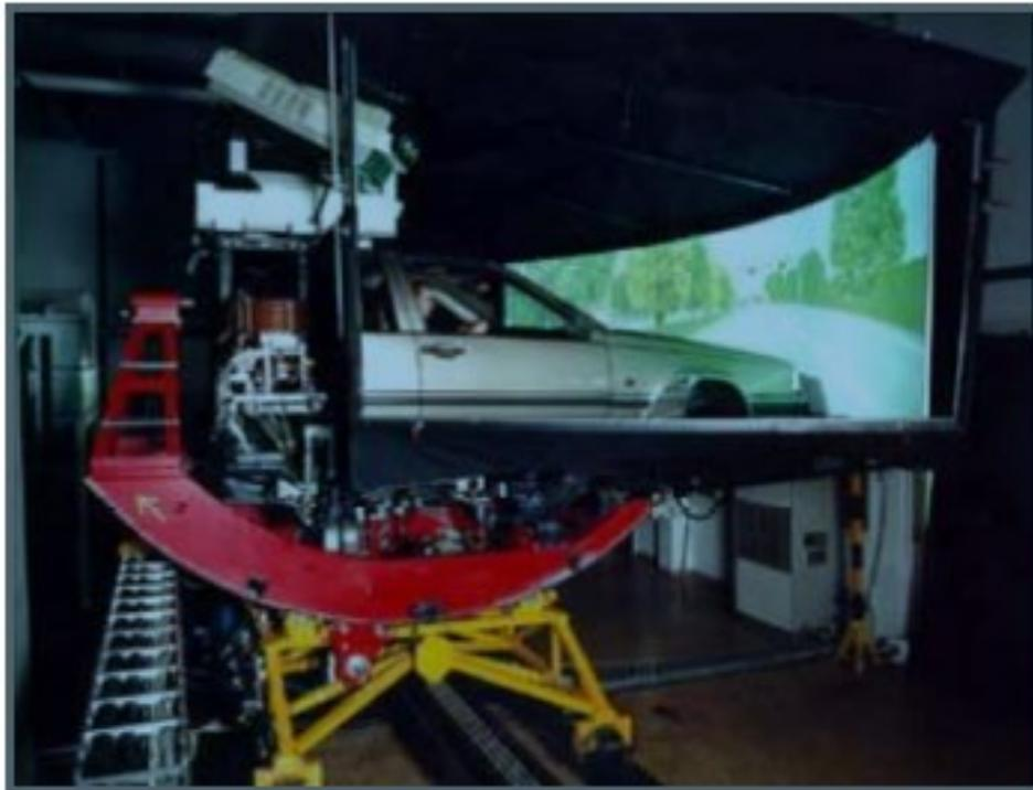
Figure I.4 : Exemple de plateforme à structure série [1]
