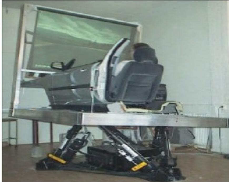
Figure I.6 : Exemple de plateforme à structure série [1]. Université de Suède
