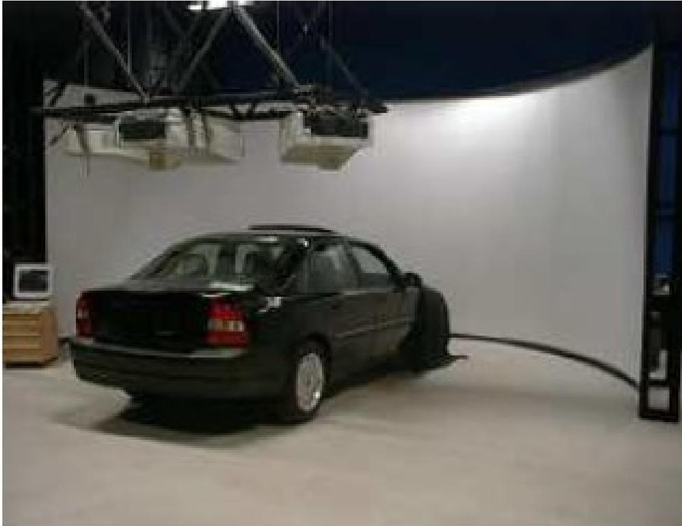
Figure I.2 : Exemple de plateforme à base fixe [1]
