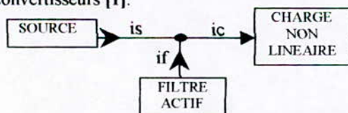
Fig. III-1 principe du filtrage actif parallèle.
