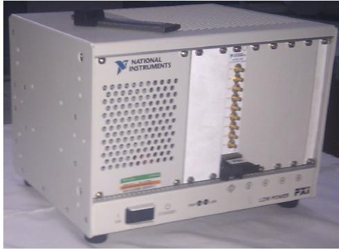
FIGURE 3.2: Carte d'acquisition NI PXI 5105
