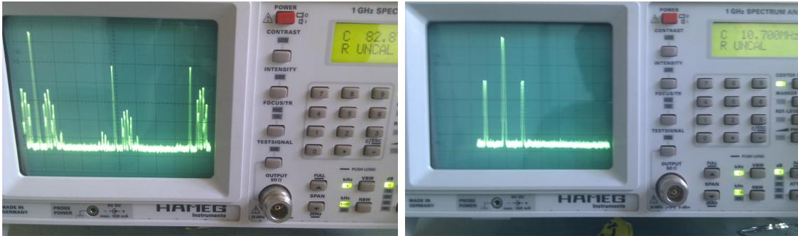
FIGURE 3.6: Signal centré à la fréquence IF à la sortie du récepteur a) Voie filtrée b) Voie non filtrée
