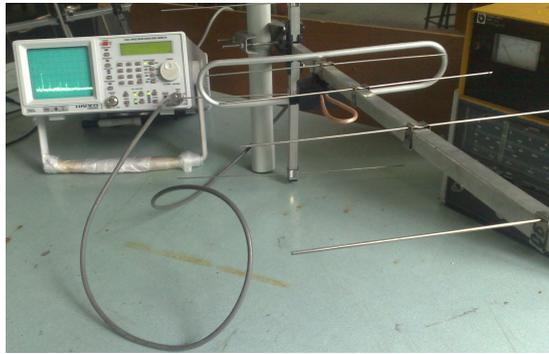
FIGURE 3.3: Exploration du spectre à l'aide d'une antenne Yagi
