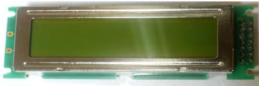
Figure 3.5: Afficheur LCD
