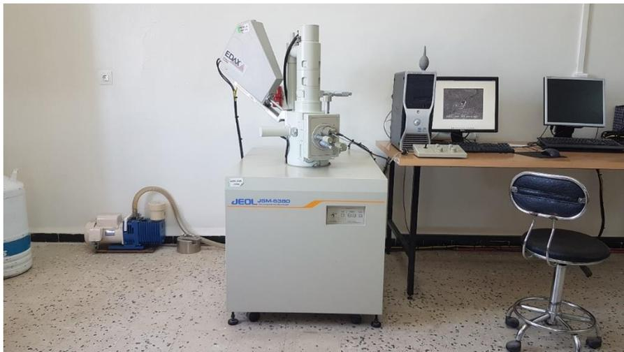
*Figure 57: microscope électronique à balayage au sien du CREDEG*
