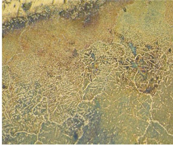
Figure 78: la phase  $\sigma$  apparue au bord d'attaque (zone 6 de l'aube vers le haut)
