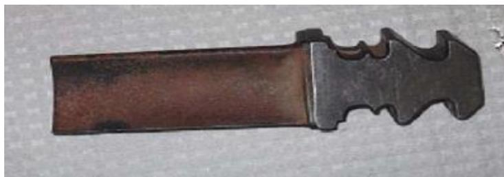
*Figure 53: L'aube de la turbine à gaz TG 9D2 (usagée)*
