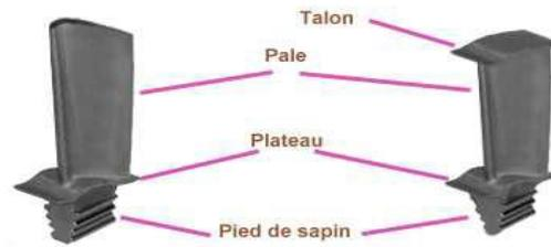
Figure 4: diffèrent partie d'une aube d'une turbine à gaz
