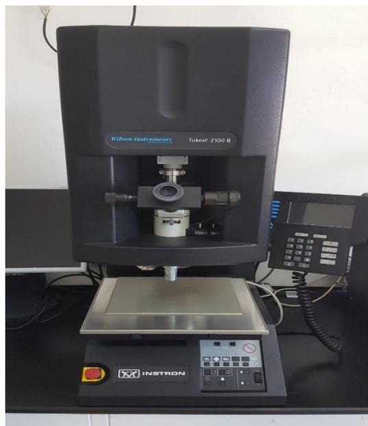
Figure 61: microduromètre au sien du CREDEG
