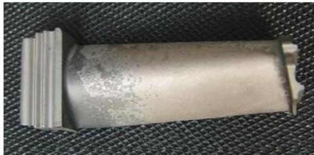
Figure 26: Attaque par sulfuration d'une aube de turbine. Ces endommagements peuvent parfois être réparés en retirant le revêtement endommagé et en appliquant un nouveau revêtement. [25]
