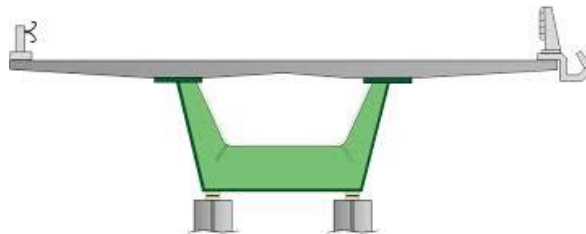
Figure II.7 : pont en poutre caisson
