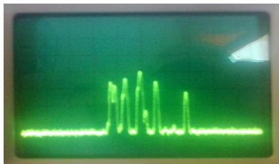
Figure III.6 : Canaux de radiodiffusion FM de 88 MHz à 108 MHz
