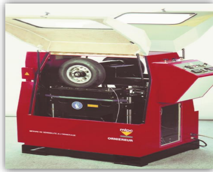
Figure III.9. Orniéreur (Mesure de sensibilité à l'orniérage) [23].
