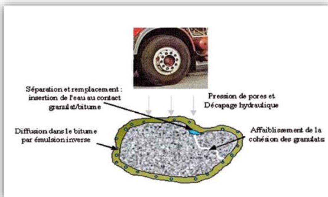
Figure III.3. L'effet de l'eau sur le couple granulats - bitume [25].
