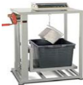
Figure III.4. Mesure de masse volumique d'une éprouvette par pesée hydrostatique.
