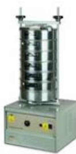
Figure II.1. Les tamis et la machine de tamisage [13].
