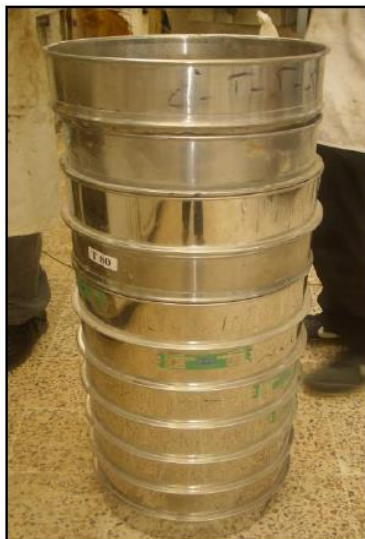
Figure II.1. Les tamis et la machine de tamisage [13].
