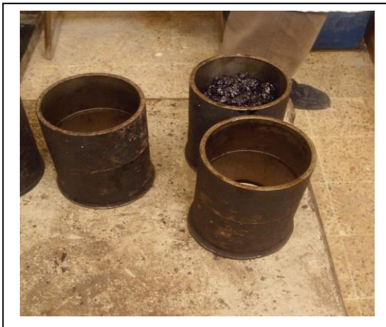
Figure V.6. Remplissage des moules Marshall.
