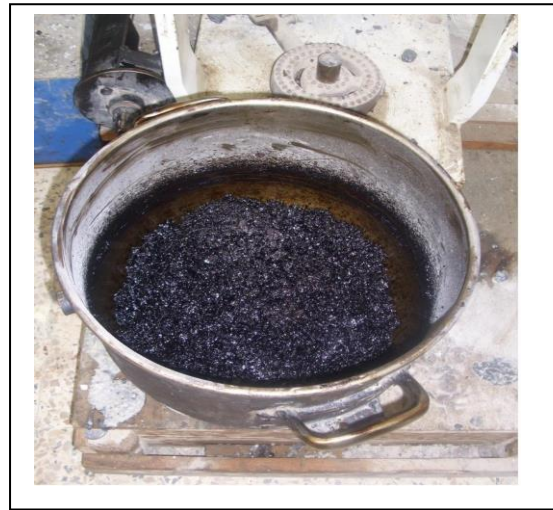
Figure V.5. Enrobé après malaxage.
