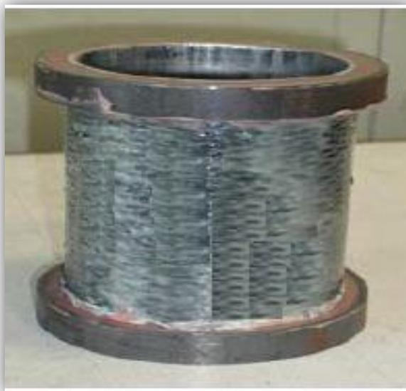
*Figure10 : Coque en acier inox renforcée par quatre couches de TFC [6]*
