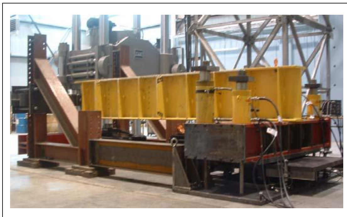
figure II.4.b : Montage d'essai sur les isolateurs sismiques [16]
