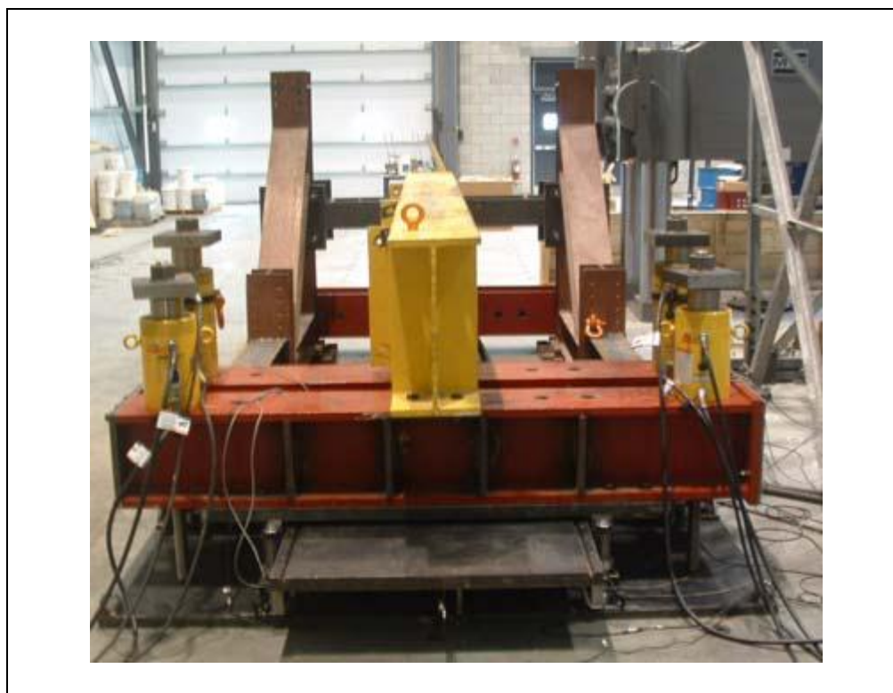
figure II.4.a : Montage d'essai sur les isolateurs sismiques [16]
