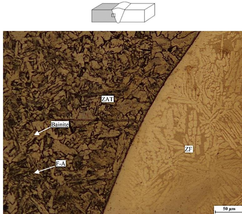
**Figure IV-5.** Micrographie optique de la ZAT côté HSLA API Gr B. Structure composée de perlite, bainite et ferrite-aciculaire.
