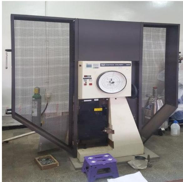
Figure III-14. Machine de résilience.
