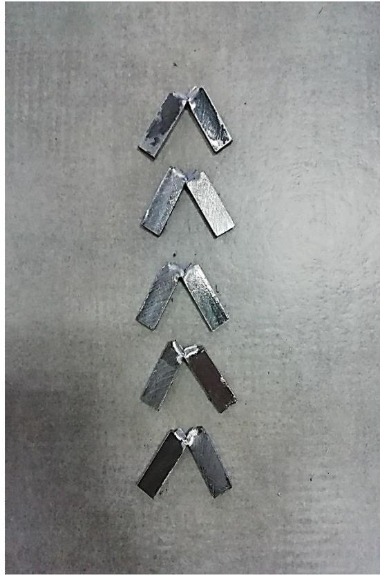
**Figure IV-14.** Eprouvettes de résilience après l'essai.
